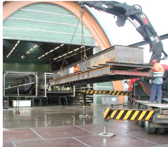
aankomst kano in Lelystad in een speciaal vervaardigde stalen bekisting voor het transport (foto NISA)
